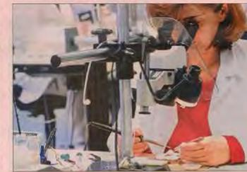
**Herstellung Hörgeräte** enthalten sehr feine Technik, die die Mitarbeiter zum Teil unter dem Mikroskop zusammensetzen müssen.
