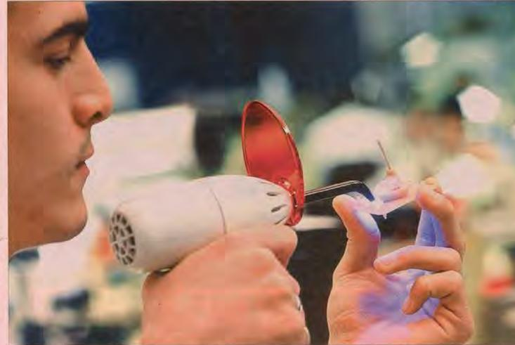
Ein Mitarbeiter von Siemens härtet Material am Ohrpassstück eines Hörgeräts, indem er es mit UV-Licht bestrahlt. Die rote Scheibe schützt seine Augen
