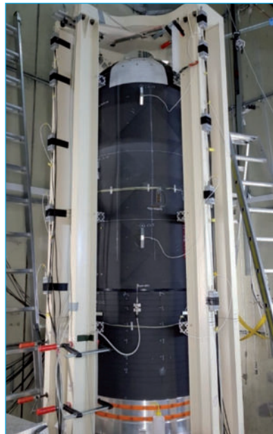
Abb. 2 u. 3: Lastrahmenkonstruktion für Strukturtest an einem großen Druckbehälter für Raumfahrtanwendungen (links), bestückt mit Schallemissionssensoren (rechts). © MT-Aerospace AG ■
