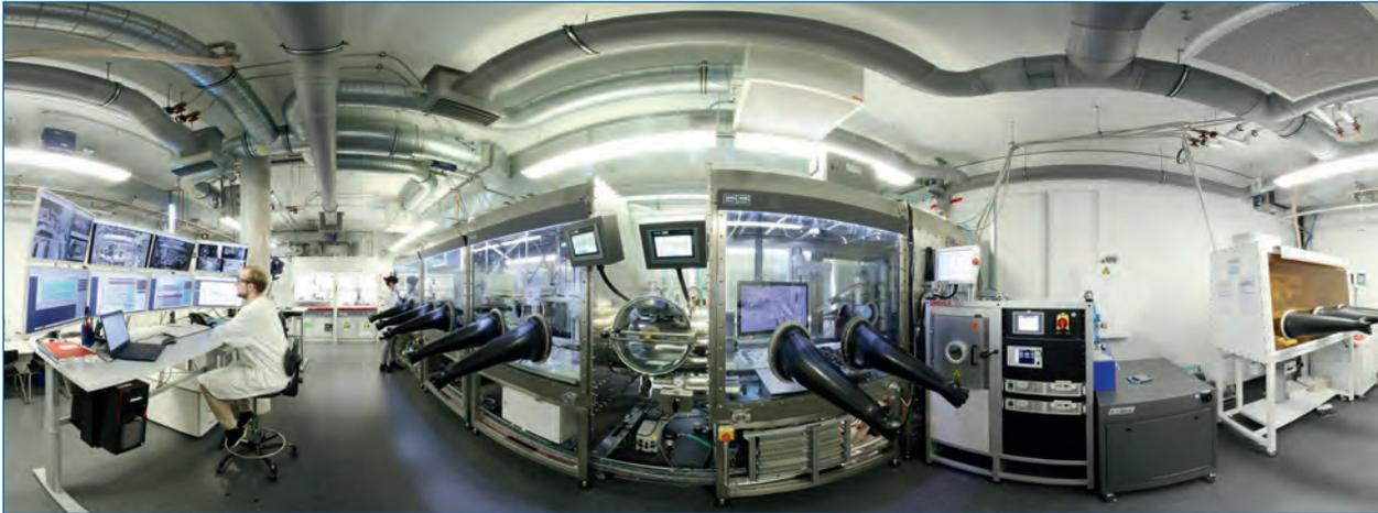
Am Helmholtz Institut Erlangen-Nürnberg wird eine automatisierte Laborplattform genutzt um neue Materialien für druckbare Halbleiter zu entwickeln. Mit der Plattform werden vollautomatisiert Solarzellen hergestellt und anschließend charakterisiert. ■
