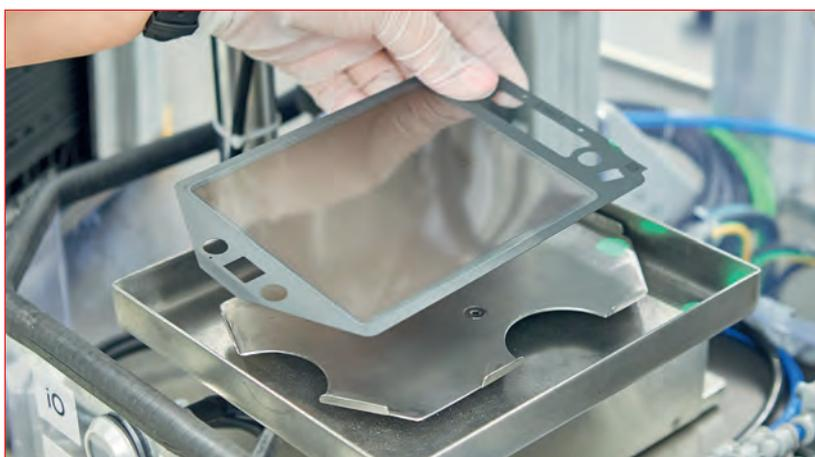
*Fertigung von Festoxid-Brennstoffzellen am Bosch-Standort in Bamberg: Prüfung einer fertig prozessierten Festoxid-Brennstoffzelle. Foto: Bosch ■*
