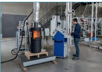
Am Feuerungsprüfstand wird das Betriebsverhalten des Ofen untersucht (Bild: TFZ) ■
