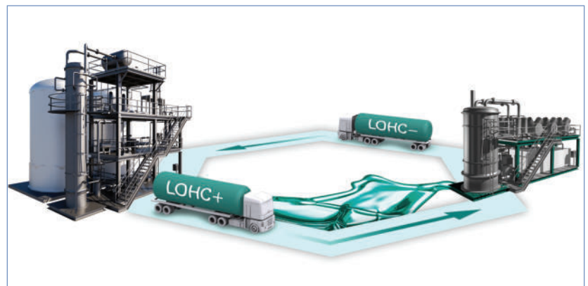
LOHC Kreislauf mit StoragePLANT und ReleaseBOX (c) Hydrogenious LOHC Technologies ■
